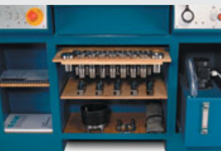
geräumiger Werkzeugschrank und Kühlmitteleinrichtung
