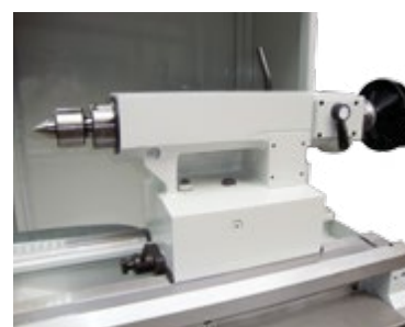
Reitstock mit Schleppvorrichtung und 1:1 und 1:4 Untersetzung für Pinolenbewegung.
