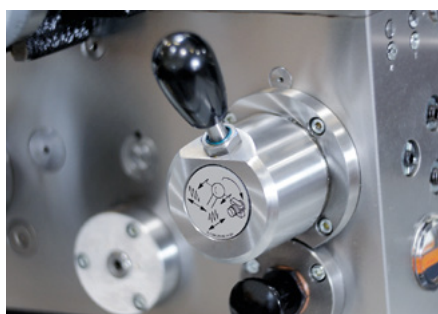
Einhebelschaltung mit Sicherheitsverriegelung
