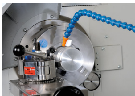
Hochgenaue Spindellagerung mit 3 vorgespannten Schrägkugellagern für hohe Traglast mit zusätzlicher Riemenzugentlastung
