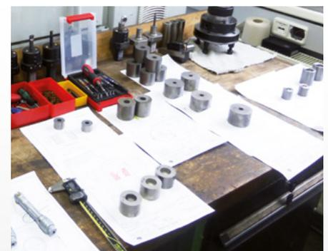
Ein kleiner Ausschnitt von Drehteilen, die bei Möhling auf der GDW C 400Z conturline gedreht werden.
