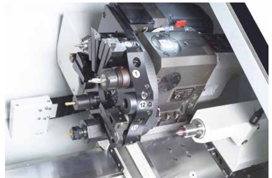
Automatischer 12-fach Werkzeugrevolver
