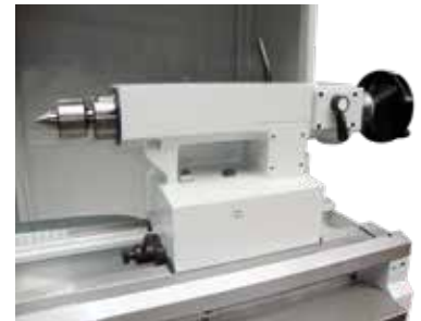
Reitstock mit Schleppvorrichtung und 1:1 und 1:4 Untersetzung für Pinolenbewegung.
