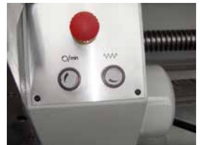
Mitfahrende Bedienelemente am Bettschlitten
