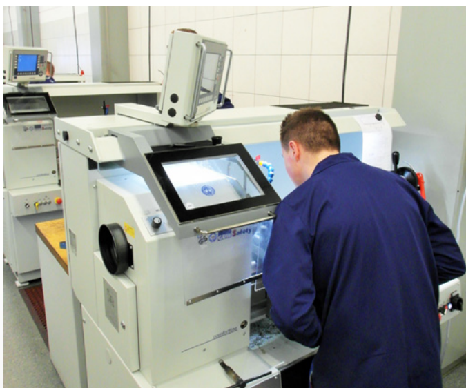
Auszubildende in der Lehrwerkstatt von GEWO Feinmechanik an GDW Drehmaschinen LZ 280VS.
