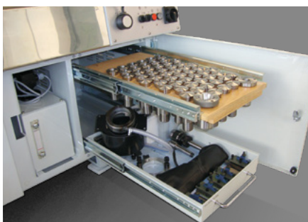
Maschinenunterbau mit herausnehmbarer Spänewanne und abschließbarem Werk- zeugschrank für Zubehör
