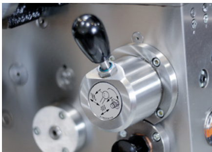
Einhebelschaltung mit Sicherheitsverriegelung
