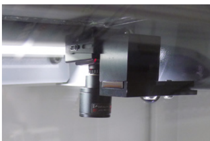
Full-HD Kamera mit Zoom, Einbau im Schiebeschutz über der Drehmitte mit Objektivschutz (optional)
