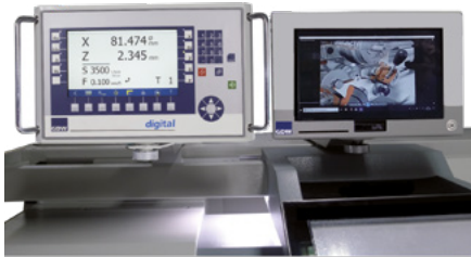
Notebook-Safe (verschießbar), schwenkbarer Notebookschacht (Quer- oder Hochformat), hochwertiges Industrie-Notebook, umfangreiche Anschlussmöglichkeiten, Netzteilanschluss für Dauerbetrieb
