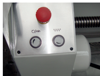
Mitfahrende Bedienelemente am Bettschlitten
